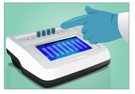
**4.** Coloque o Indicador Biológico processado e o controle positivo na incubadora pelo período indicado na etiqueta da ampola. Recomendação: verifique os resultados, repita a incubação e registre-os.
