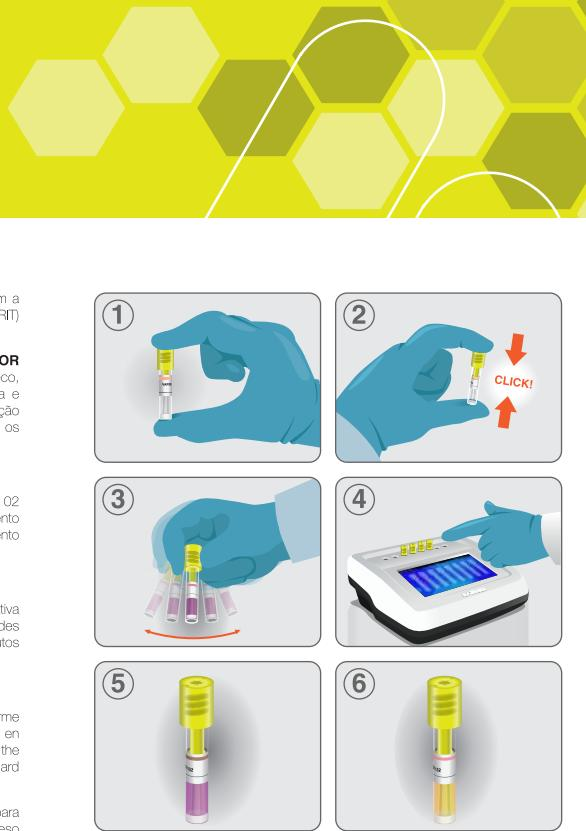
**IMPORTANTE:** transportar, armazenar, ativar, incubar e descartar sempre na posição vertical (tampa para cima) para evitar vazamentos após a ativação do produto.
